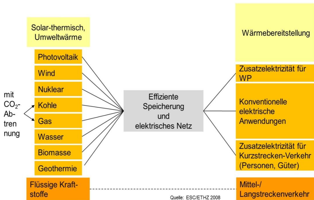
Abbildung 3: Effizienzerhöhung und Entkarbonisierung durch CO 2 -arme Energieträger: Elektrizität als Rückgrat des zukünftigen Energiesystems
